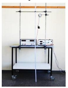
Das Netzgerät wird auf 2,5 V eingestellt. Wenn man den Taster betätigt, zieht der Motor das Gewichtsstück hoch.
